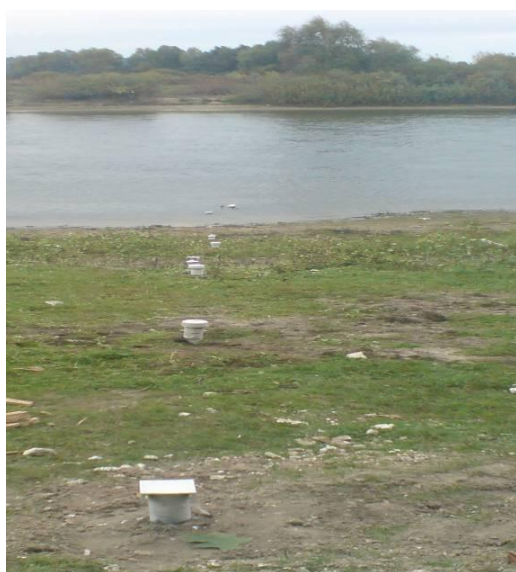
Рис. 3. Сваечный а) и рельсовый б) гидрологические посты
